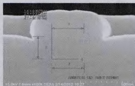
(c) 注入并退火多晶刻蚀 SEM 图
