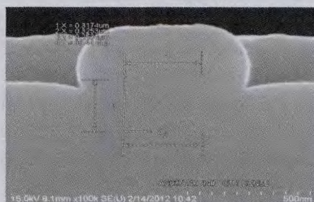
(b) 注入未退火多晶刻蚀 SEM 图
